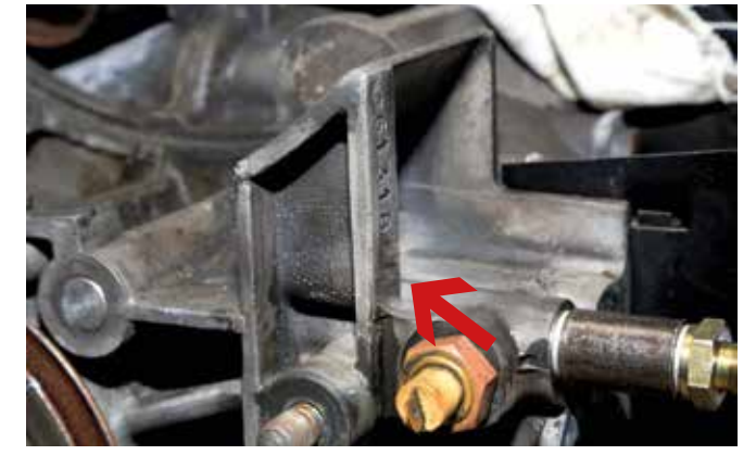
Ici un bloc magnésium. On remarque des imperfections sur l'arête où se situe le numéro.
