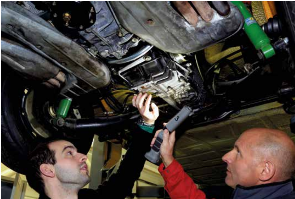
En raison de sa position, le numéro de boîte a souvent frotté et devient illisible.
