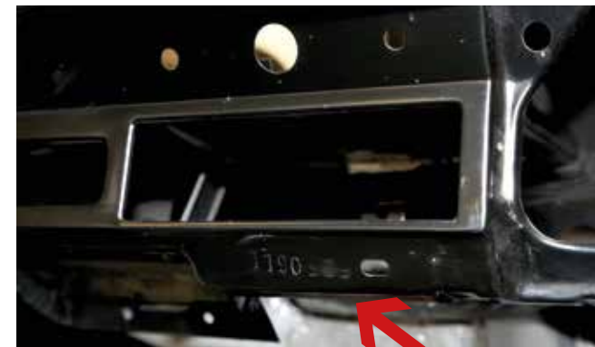
Le numéro de production est sous le tableau de bord.
