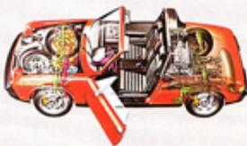
**1969** Création de la société VW-Porsche. Présentation à Francfort des VW-Porsche 914/4 (flat four VW 1.7, 80 ch, injection, 177 km/h) et 914/6 (flat six Porsche 2.0, 110 ch, 2 carburateurs triple corps Weber, 201 km/h). Deux prototypes de 914 à moteur 8 cylindres à plat Porsche.
