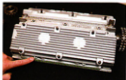
イギリスから来たエンジンが「日産大工の件」だった理由のひとつは何と、ヘッドとヘッドカバーのスタッド位置が違っていた！ 本来は指の位置にヘッドスタッドがある。
