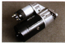
まるで新品のような、オーバーホールを済ませたスターターモーター。手前の黒いカバー部はサンドブラストとクロマタージュに続き、エポキシ系の保護塗装が施された例。
